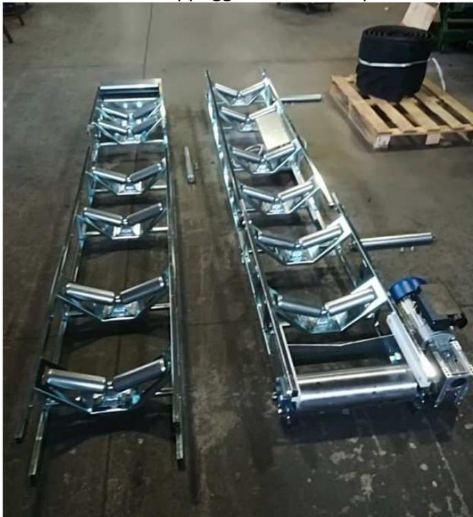
2 – Montare il telaio intermedio con il telaio di comando,
