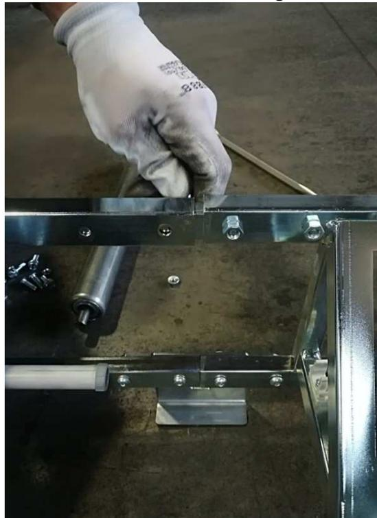
4 – Prendere la testata di tensione e smontare il cilindro di tensione, le lamiere di tensione, il raschiatore e il rullo di ritorno
