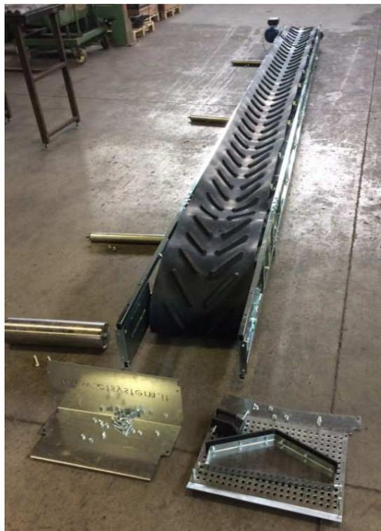
8 – Rimontare il cilindro di tensione, i rulli di ritorno e le lamiere di tensione.
