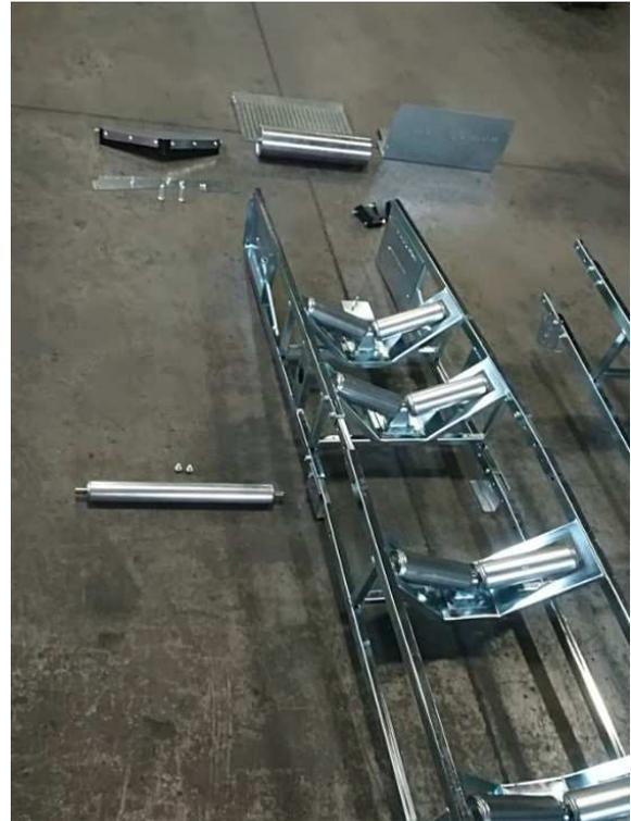
5 – Montare il telaio intermedio con il telaio di tensione e avvitare saldamente le giunzioni
