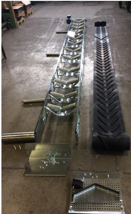
7 – Das Gummiband zuerst in den Spanrahmen, dann in den Motorrahmen einfügen
