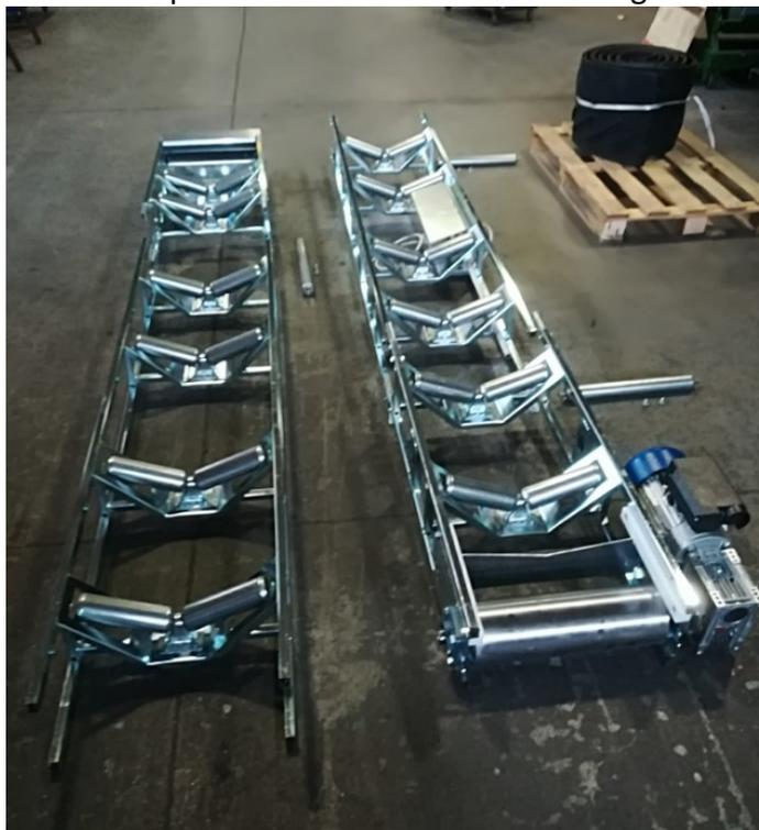
2 – Den Mittelrahmen mit dem Motorrahmen verbinden,
