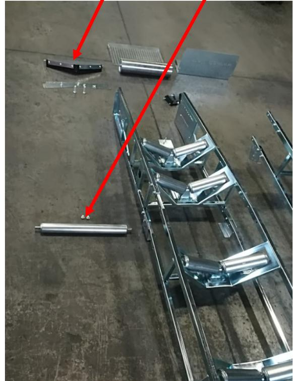
5 – Den Mittelrahmen mit dem Umlenkrahmen verbinden und die Verbindungslaschen fest zusammenschrauben
