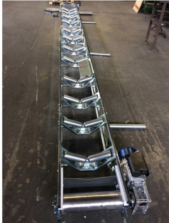
6 – Das Gummiband neben dem montierten Rahmen ausrollen
