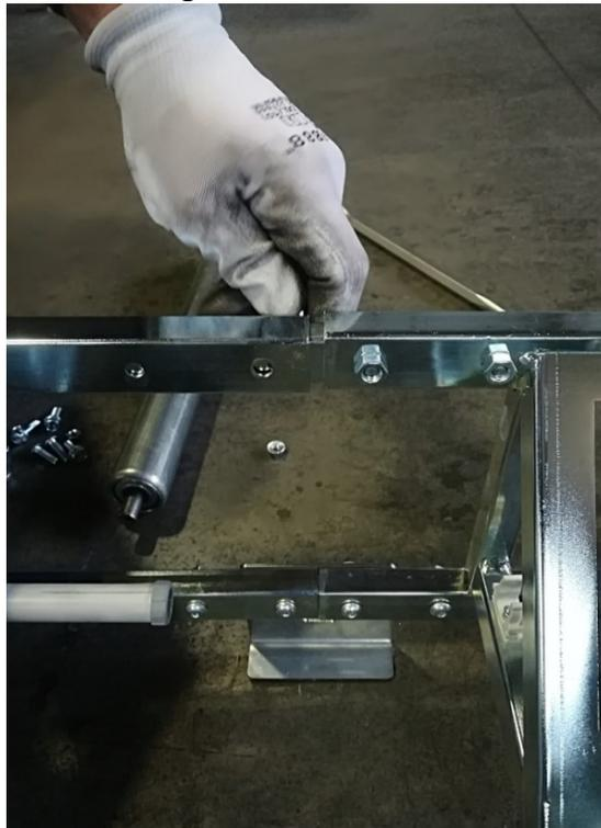
4 – Am Umlenkrahmen den Spannzylinder, die Spannbleche, den Schaber und die Stützrolle abmontieren
